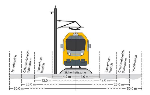
Die Sicherheitszone erstreckt sich vier Meter beiderseits der äußersten Gleisachse.
